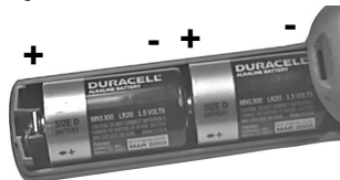
Figura 5. Batterie alcaline installate correttamente
